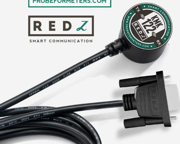
La REDZ KMK122 è una sonda ottica progettata in conformità alla norma IEC 62056-21 ed è compatibile con tutte le marche e i tipi di contatori omologati IEC. La sonda ha un'interfaccia con un cavo di connessione specialmente ideata per connettersi direttamente alle unità portatili Honeywell Serie 9900.
